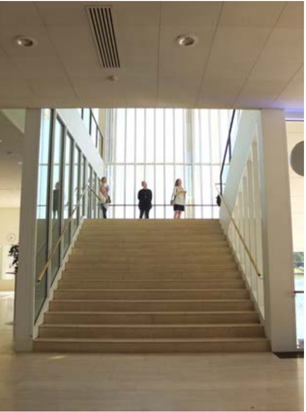
↑ Ensimmäisestä kerroksesta alkava leveä avoporras johtaa Tapiolasalin ylempiin lämpiöihin. Ylempänä ja muualla lämpiöiden portaissa on Hille Kaukosen suunnittelema lasikaide, tässä alimmassa porrassyöksyssä messinkinen käsijohde on kiinnitetty lasiseinä-rakenteeseen. amoy 2020
